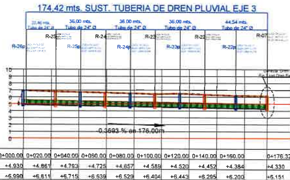
PERFIL DE DREN PLUVIAL EJE No. 3
